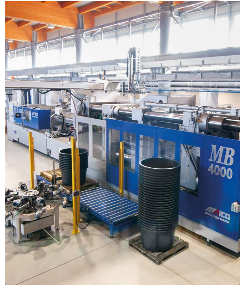
Pressa specifica per produzione di grandi contenitori Maschine spezifisch für das Herstellen von großen Behälter. Prensa específica para la producción de grandes recipientes.
